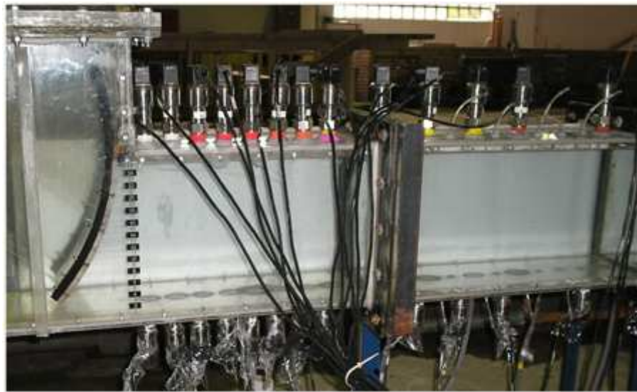
Figura 4.2 – Modelo experimental: transdutores eletrônicos de pressão instalados no teto e na base do conduto a jusante da comporta.
