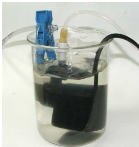
Figura 3.5 Reservatório e a bomba de água.
