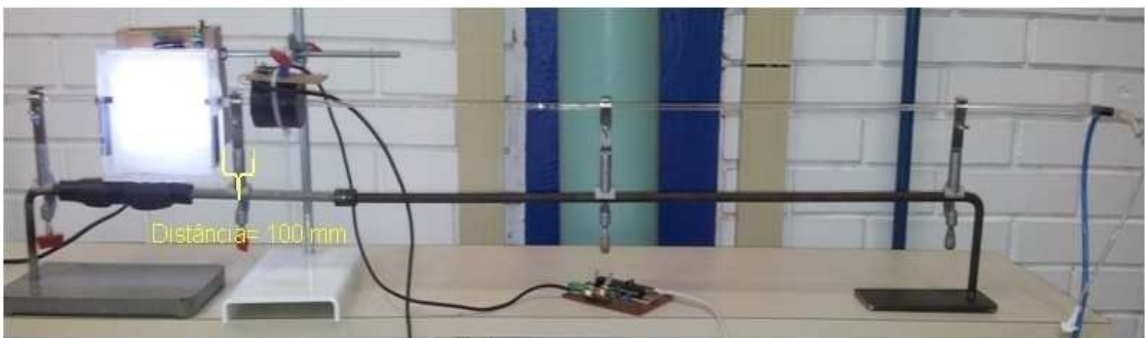
Figura 4.9 Alteração na posição do sensor óptico na seção de testes.
