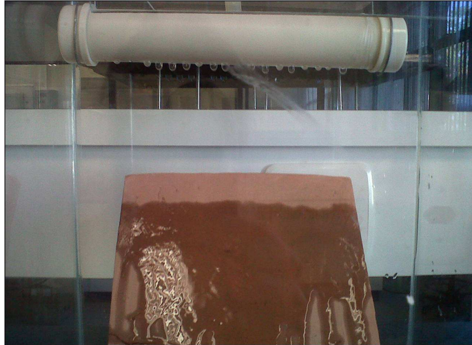
Figura 17 - Esquema de distribuição da solução lixiviante.
