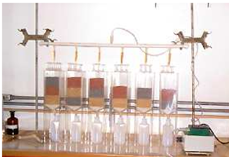
Figura 5 - Teste de lixiviação em coluna para material granular.
