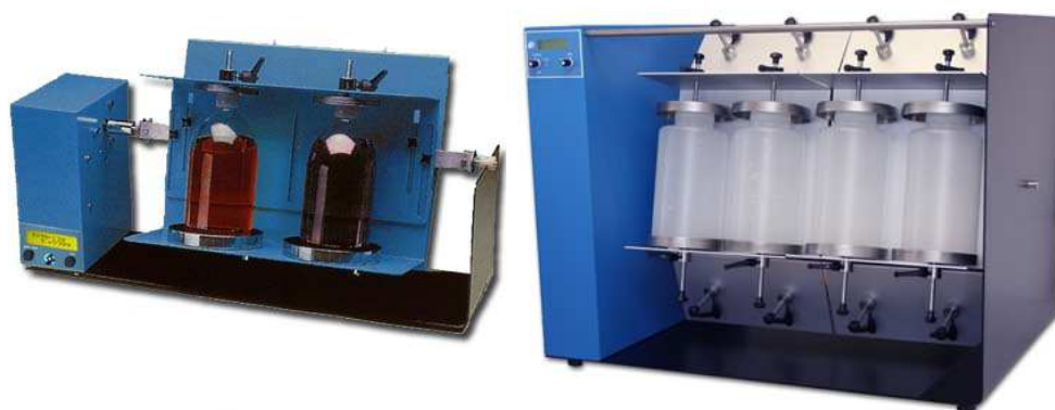
Figura 6 - Teste de lixiviação em batelada
