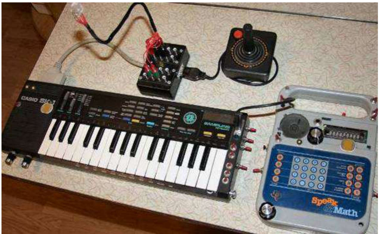
Figura 1: Exemplo de circuit bending : teclado musical é ligado a um joystick do console Atari 2600 e a um Speak & Math, brinquedo utilizado para ensinar matemática às crianças.
