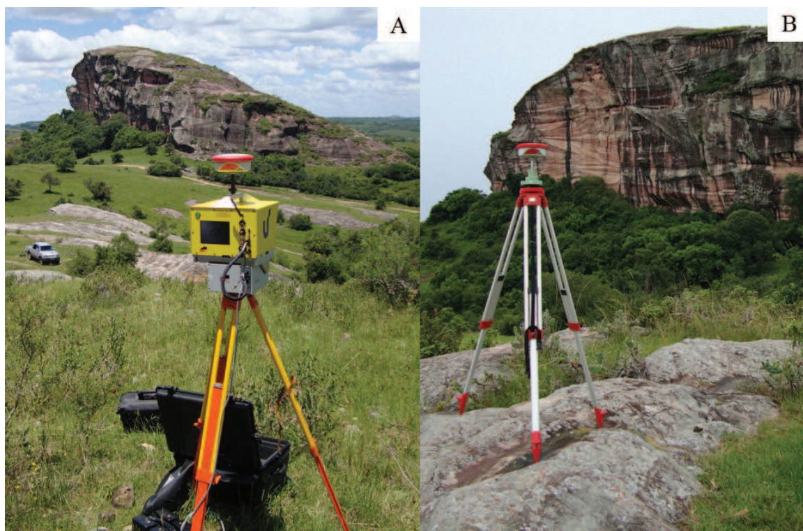
Figura 4 - Equipamentos utilizados na etapa de imageamento. (A) Laser Scanner Terrestre Optech; (B) Receptor GNSS.
