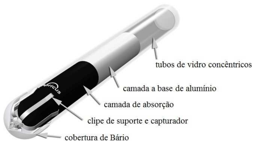
Figura 2.3 – Tubo coletor solar isolado a vácuo. Fonte: Apricus (2012)
