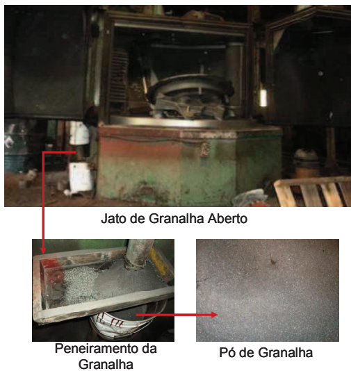
Figura 13 - Equipamento de Jato de Granalha Fonte: Elaborada pela autora
