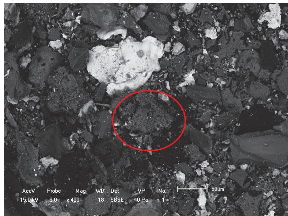
Figura 38 - Ponto 3 identificado na micrografia Resíduo PG (aumento de 400x) Fonte: Elaborado pela autora
