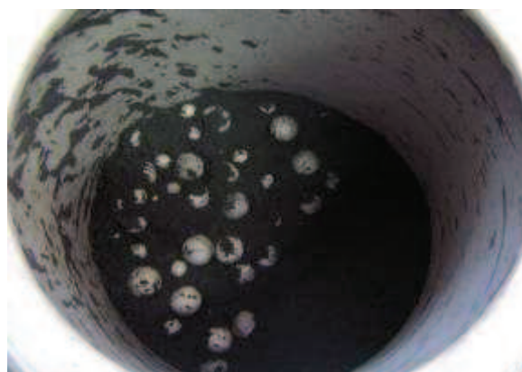
Figura 42 - CCA moída por 4 horas Fonte: Elaborado pela autora
