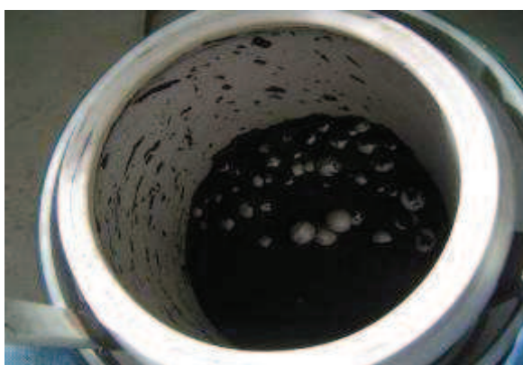
Figura 41 - CCA moída por 2 horas Fonte: Elaborado pela autora
