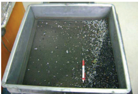
Figura 14 - CCA retida na peneira 1,2mm Fonte: Elaborada pela autora
