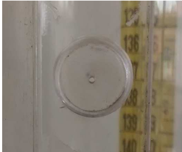
Figura 29 – Tomada de pressão no leito
