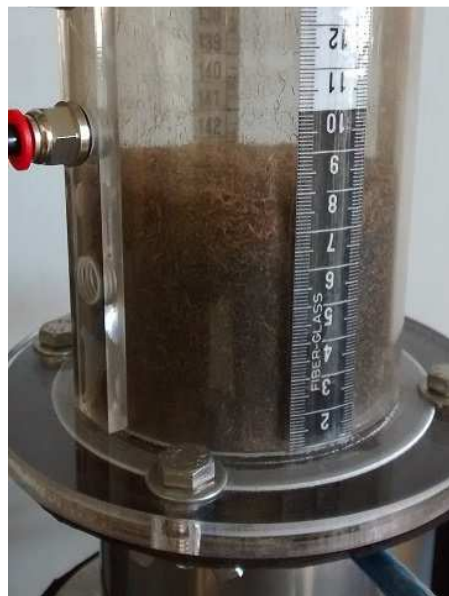
Figura 23 – Medição da altura inicial do leito
