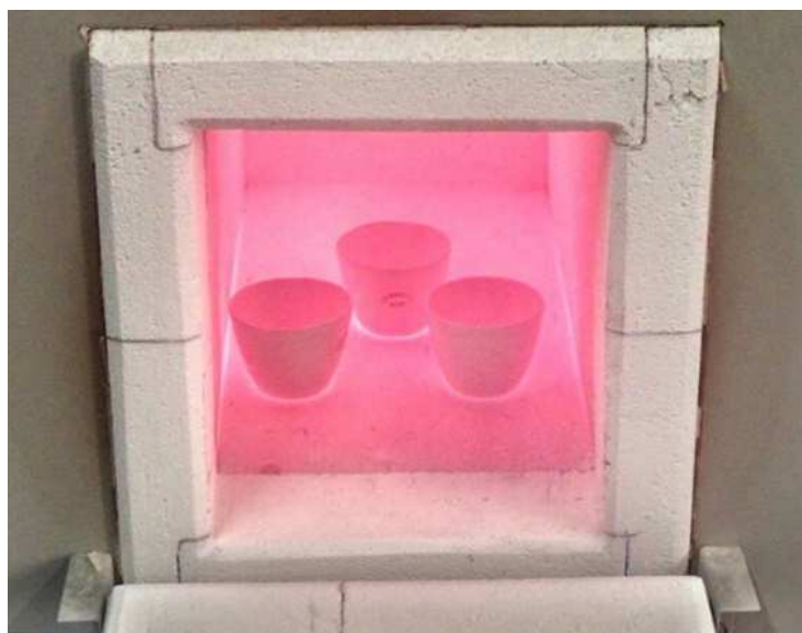
Figura 70 – Amostras em resfriamento na análise de perda ao fogo
