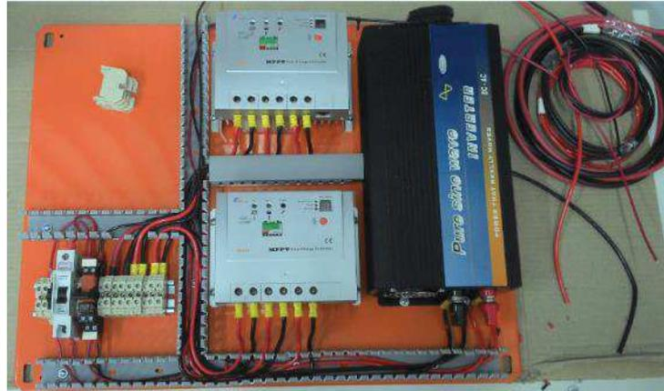
Figura 4.8 - Montagem do quadro de comando em bancada.
