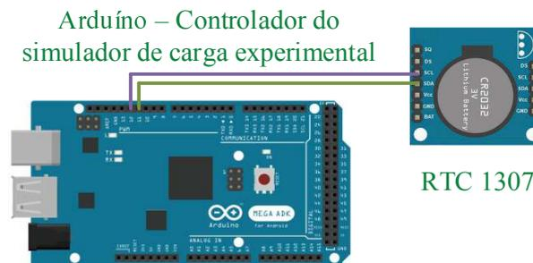
Figura 4.19 - Ligação RTC no simulador experimental.
