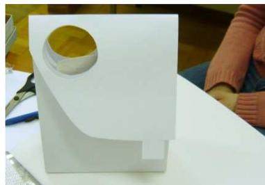
**Figura 4.29:** *Mock-up* com erro na altura da sacola (produto aparecendo).
