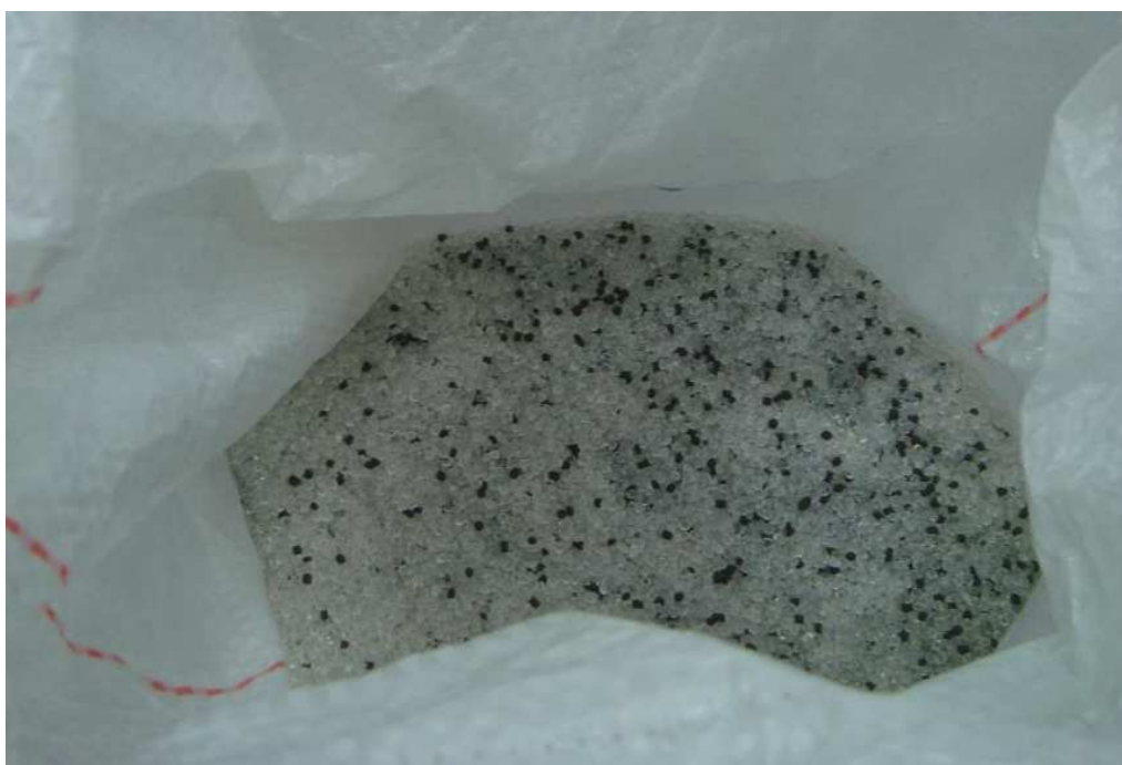
Figura 33 – Material reciclado de TPU já misturado com material virgem
