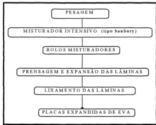
Figura 15 – Fluxograma de produção do EVA
