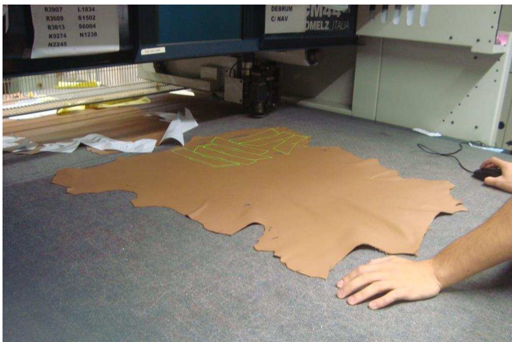
Figura 32 – Modelagem CAD sendo utilizada para o corte de couro
