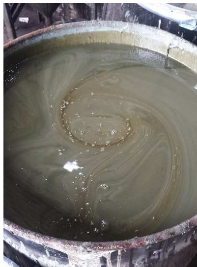
Figura 6 – Aspecto da borra de tinta na saída do destilador.
