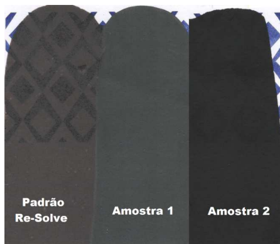
Figura 7 – Testes de cobertura para tintas fundo serralheiro recuperadas.
