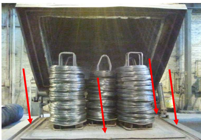
Figura 19 - Calhas de vedação - Fornos de Recozimento.
