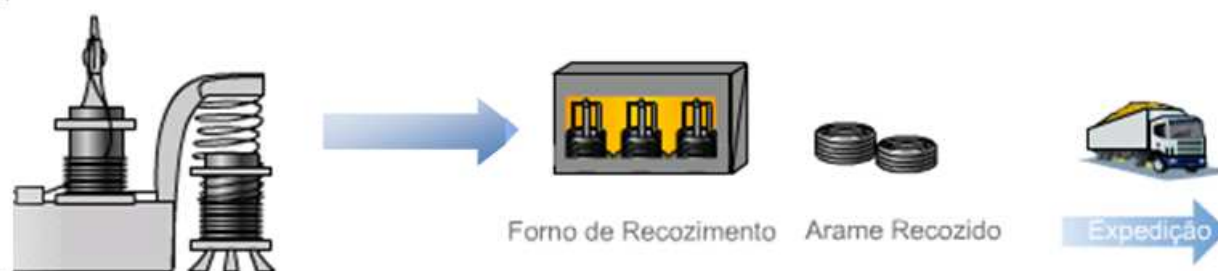
Figura 10 - Fluxo de produção do arame recozido.
