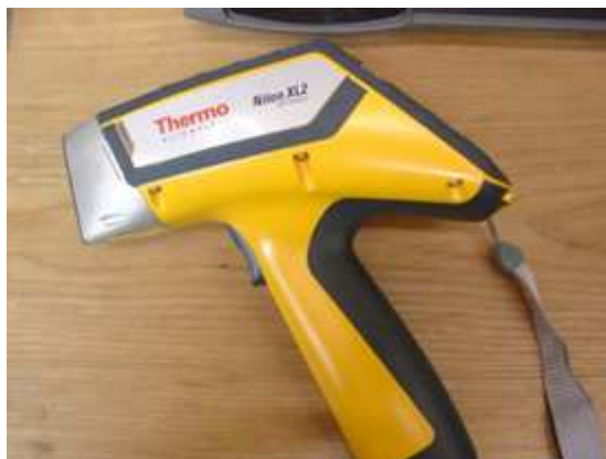
Figura 3: Foto do analisador de ligas Niton XL2 980 GOLD (Fonte: Elaborada pelo autor)
