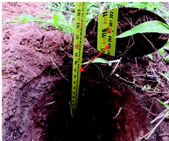
Figura 3.4: Perfuração com 0,3 m de diâmetro e 3 m de profundidade.
