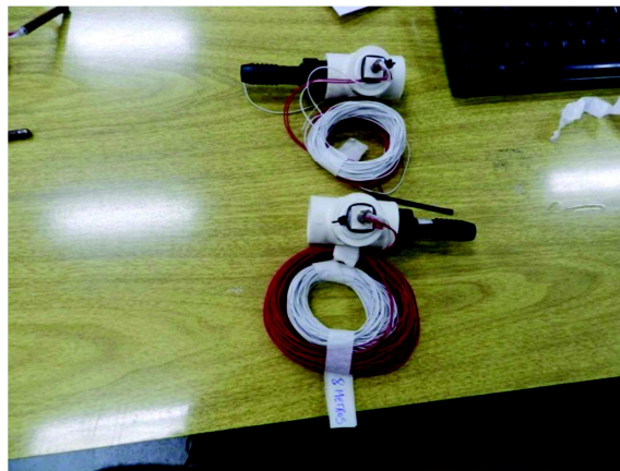
Figura 3.6: Sensores PT 100 preparados para a entrada e saída do trocador.
