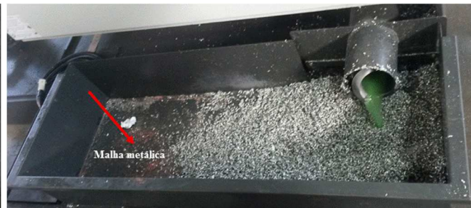
Figura 13 – Malha metálica coletora em detalhe do grupo 2
