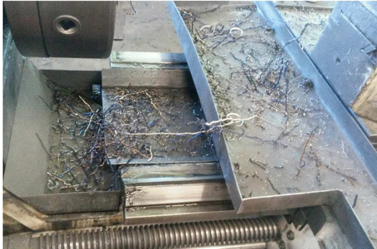
Figura 15 - Segregação por plano inclinado do grupo 3 (Empresa B)
