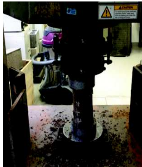
Figura 8b: Ensaio de resistência à compressão simples em corpos de prova cilíndricos.
