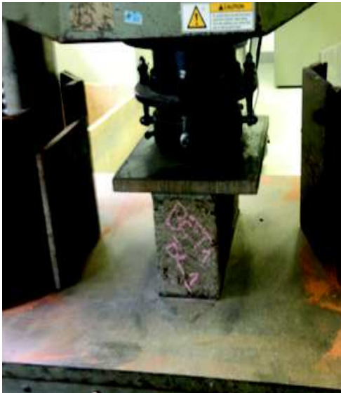
Figura 8a: Ensaio de resistência à compressão simples em blocos de vedação.
