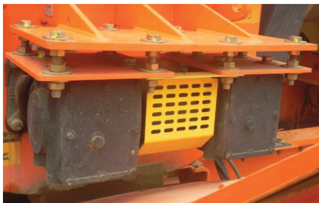
Figura 28 – Proteção no eixo de transmissão.
