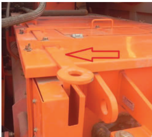
Figura 30 – Intertravamento na tampa do Misturador.
