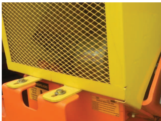
Figura 32 – Fixação das proteções.
