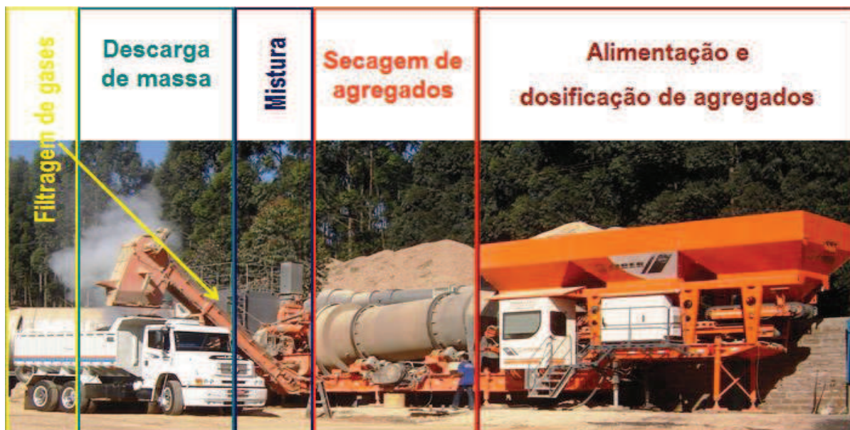
Figura 1 - Modelo de processo de uma usina móvel de mistura externa a quente, com processo de secagem contra fluxo e dosificação por pesagem dinâmica.
