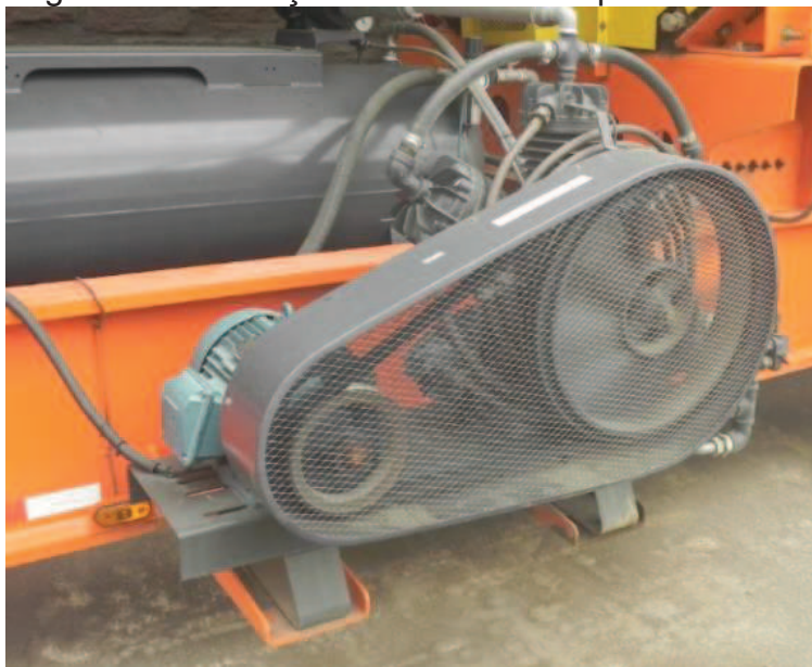
Figura 39 – Proteção correias do compressor de ar.
