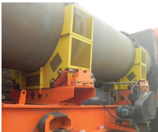
Figura 25 – Proteção no sistema giratório.
