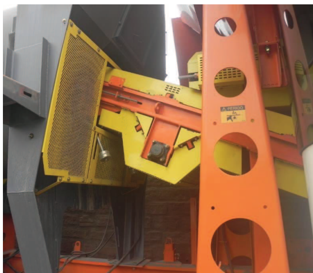
Figura 29 – Proteção na ligação da esteira com a câmara de exaustão.
