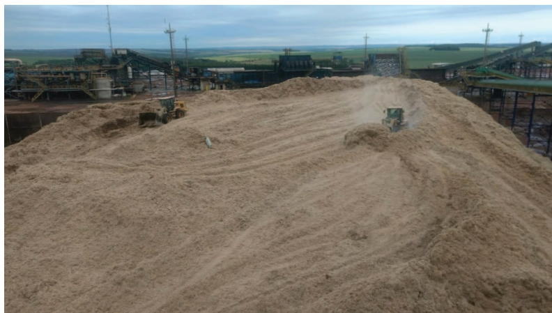
Figura 30 - BCA armazenado para combustão nas caldeiras da Usina 02
