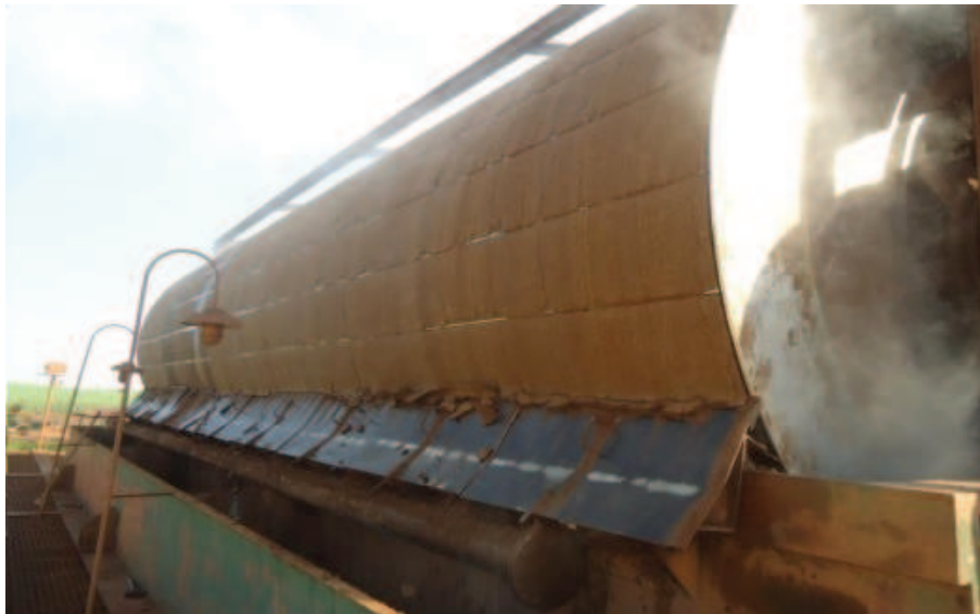
Figura 11 - Detalhe do funcionamento do filtro rotativo com a retirada da torta de filtro
