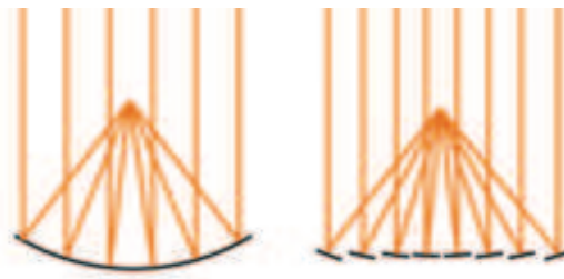
Figura 3.1 - Comparação da concentração da radiação entre o coletor parabólico e o coletor Fresnel linear.
