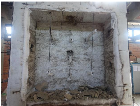
Figura 68 – BOR10% após ensaio de resistência ao fogo: vista interna do forno vertical
