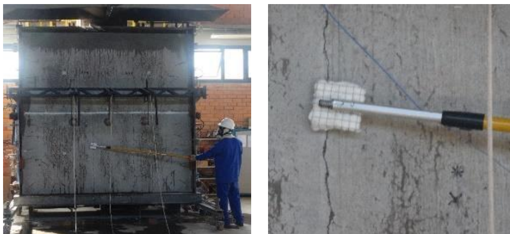
Figura 45 – Teste de estanqueidade: (a) execução e (b) algodão
