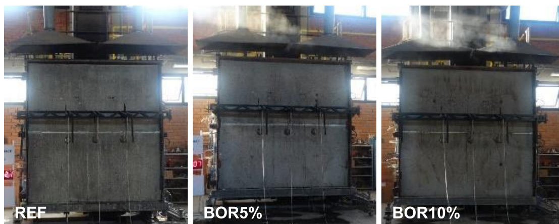
Figura 63 – Amostras REF, BOR5% e BOR10% aos 150 min de ensaio de resistência ao fogo
