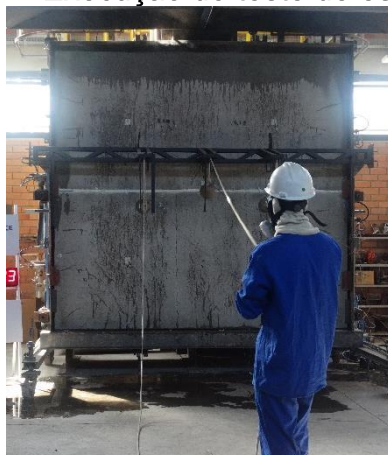
Figura 47 – Execução do teste de estabilidade
