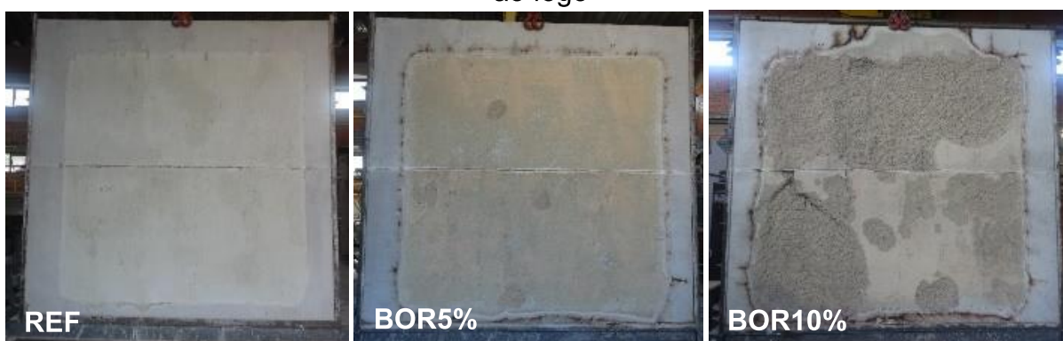
Figura 64 – Superfície exposta REF, BOR5% e BOR10% após ensaio de resistência ao fogo
