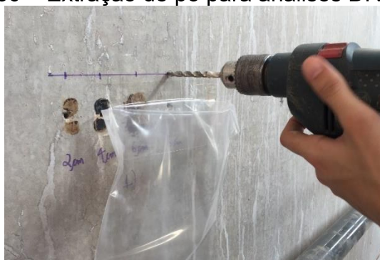
Figura 50 – Extração de pó para análises DRX e FRX
