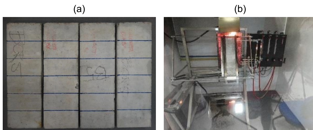
Figura 34 – Determinação do índice de propagação superficial de chama: (a) amostras e (b) aparato de ensaio
