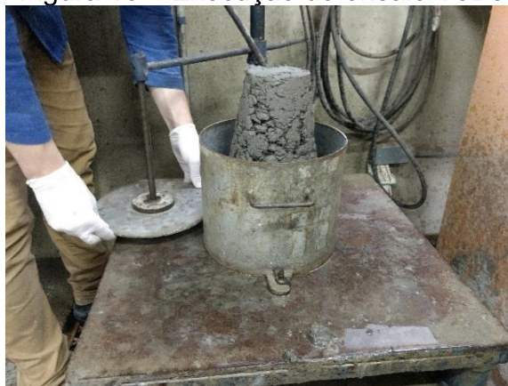
Figura 16 – Execução do ensaio VeBe
