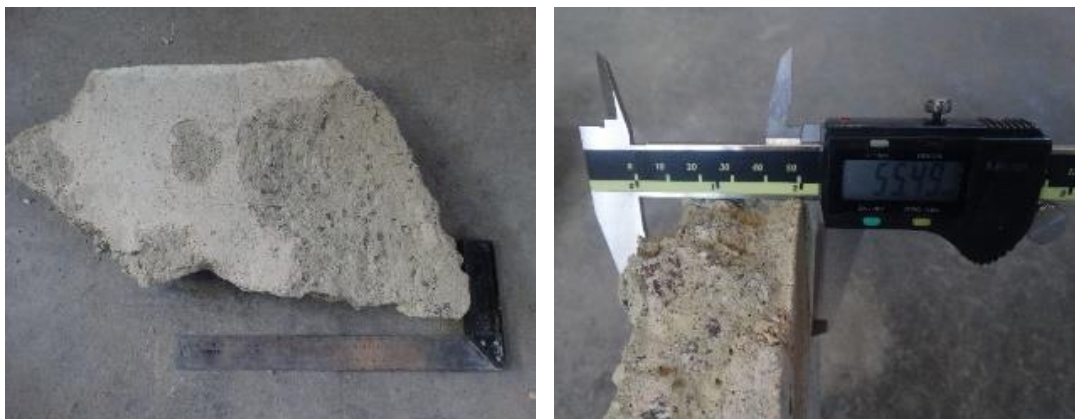
Figura 67 – BOR10% após ensaio de resistência ao fogo: fragmentos de concreto
