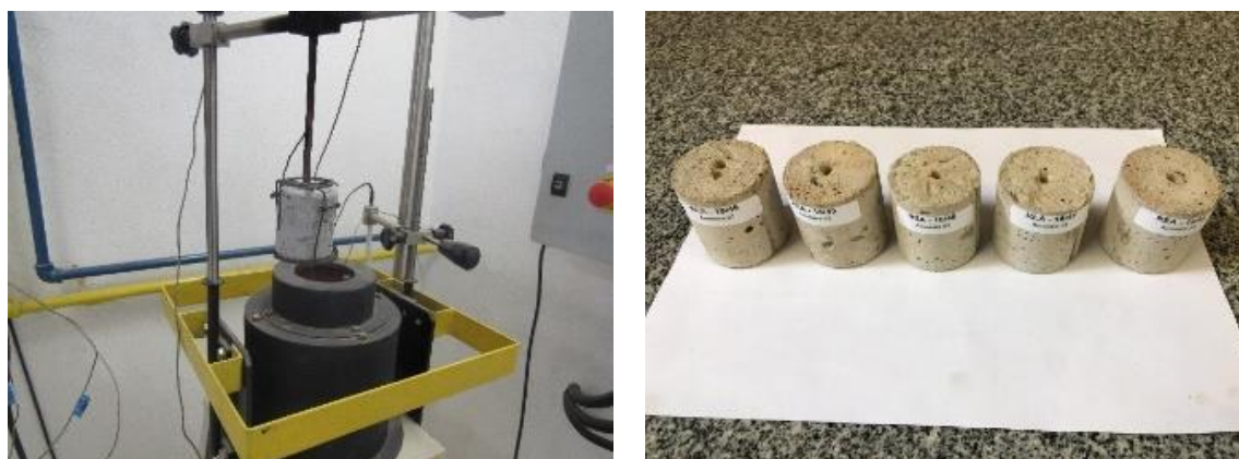
Figura 33 – Ensaio de incombustibilidade: (a) aparato de ensaio e (b) amostras
