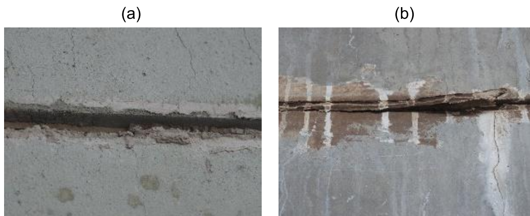
Figura 72 – Detalhe do selante do REF após ensaio de resistência ao fogo: (a) na superfície não exposta e (b) exposta
