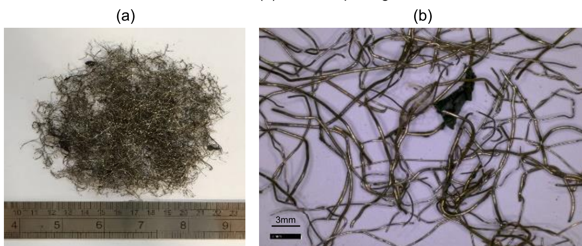
Figura 21 – Amostra da fibra de aço reciclada da etapa final: (a) máquina fotográfica comum e (b) microscópio digital
