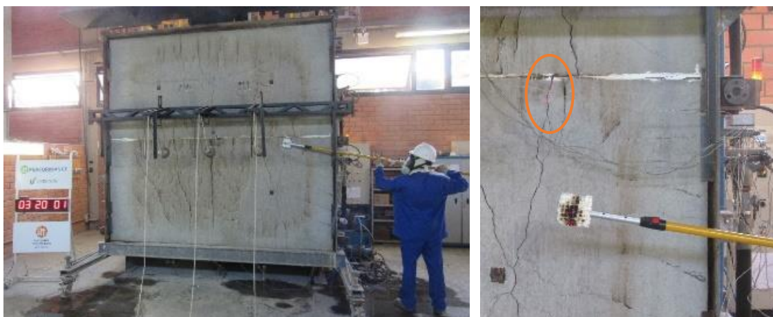
Figura 73 – Perda de estanqueidade de BOR10%
