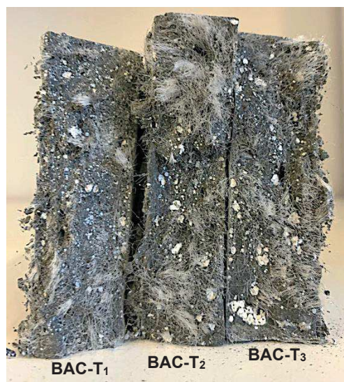
Figura 113 – Dispersão da PE na seção transversal dos exemplares com diferentes teores de concentração (após análise da regeneração)
