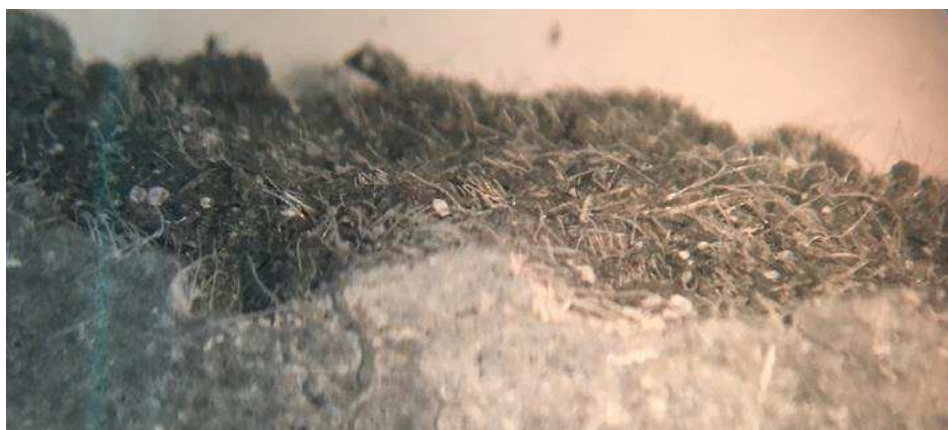
Figura 97 – Forma de ruptura das fibras de PVA no ECC após ensaio de tração na flexão, utilizando microscópio óptico
