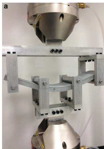
Figura 2 – Deflexão acentuada registrada em uma placa de ECC
