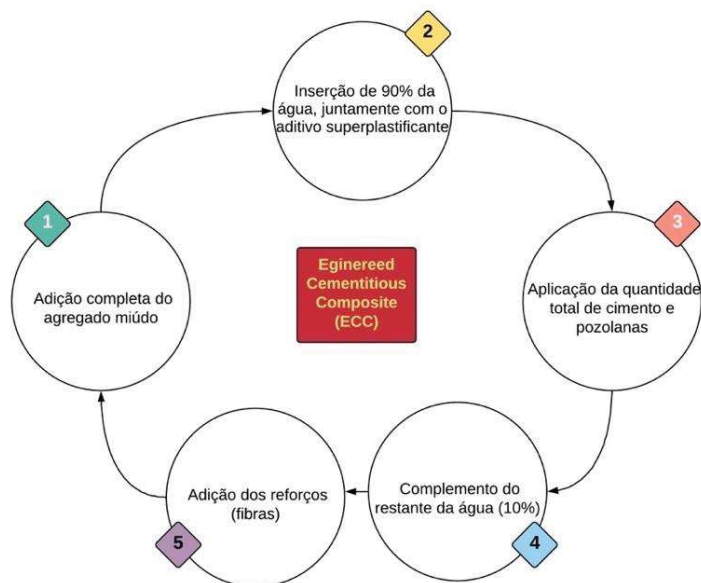
Figura 42 – Sequência tradicional de mistura dos insumos na produção do ECC
