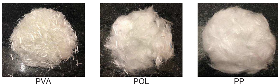
Figura 64 – Fibras utilizadas na confecção dos ECCs desta pesquisa
