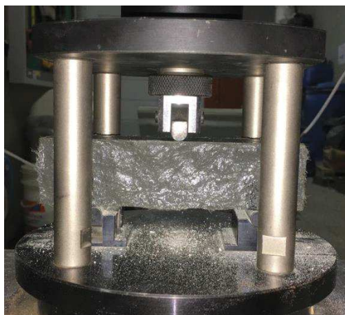
Figura 80 – Instrumentação do exemplar prismático no ensaio de tração na flexão 3 pontos
