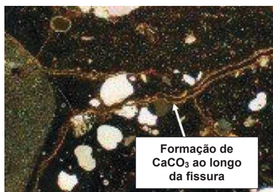
Figura 46 – Presença de \text{CaCO}_3 ao longo da superfície de uma fissura
