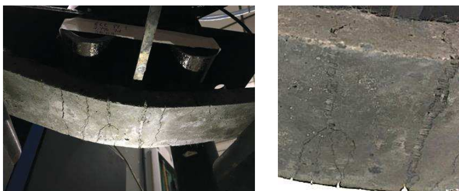
Figura 86 – Alongamento das fibras de PP em fissuras durante o ensaio de tração na flexão (a) amostra submetida ao ensaio (b) aproximação para verificação do formato da fissuração
