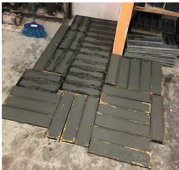
Figura 72 – Formas de madeira preenchidas com o ECCPVA
