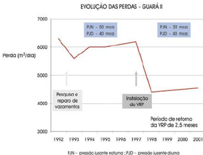
Figura 22 - Redução de vazamentos com a utilização de VRP
