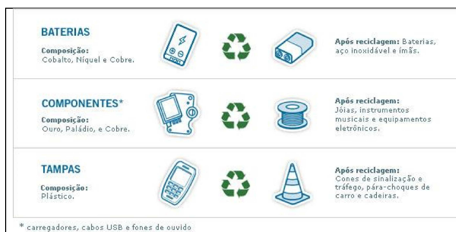
Figura 4 - Aplicações após reciclagem de componentes de aparelhos celulares
