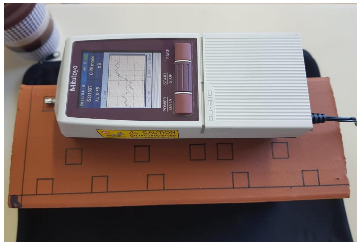
Figura 5: Equipamento de leitura de contato: rugosímetro 2D.
