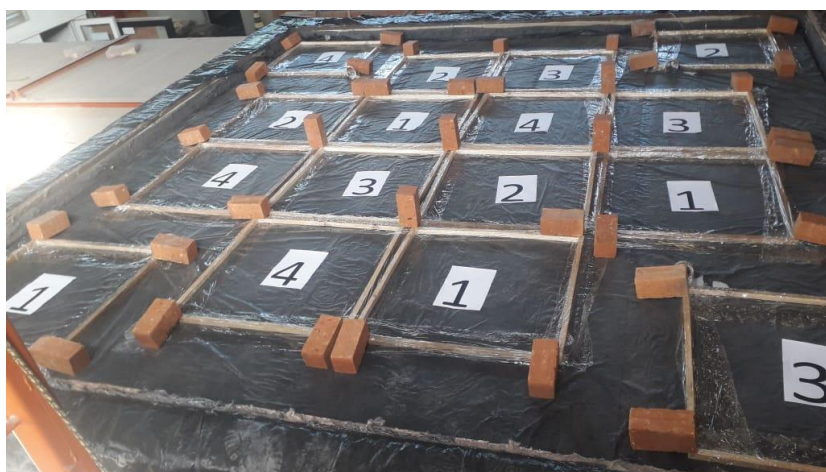
Figura 81: Distribuição das fôrmas sobre a laje de concreto, com sua identificação
