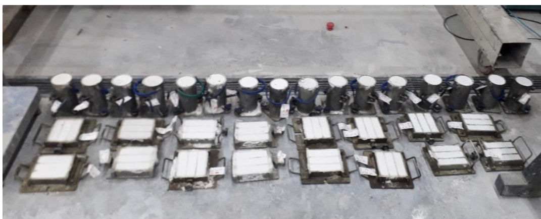
Figura 19: Moldagem dos corpos de prova
