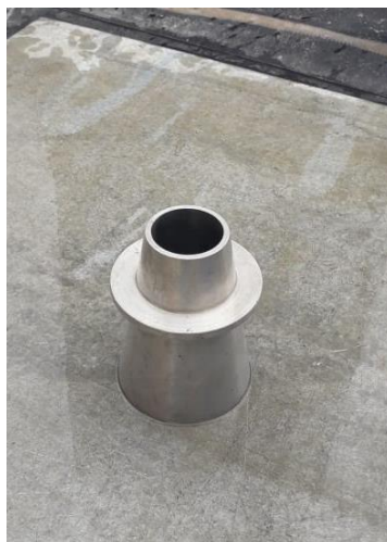
Figura 3: Mini slump com diâmetro inferior 100 mm, diâmetro superior 50 mm e altura 100 mm
