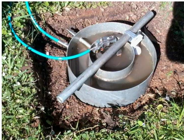
Figura 19: Ensaio de infiltração com infiltrômetro de duplo anel
