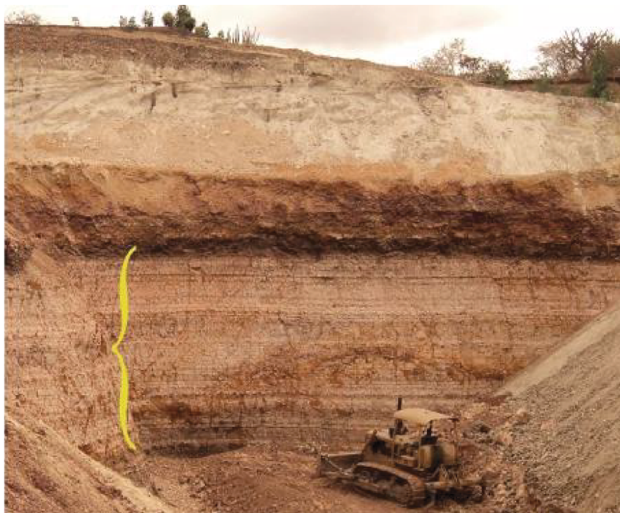
Figura 7. Vista geral dos níveis de bentonita, sobrepostos por areias com estratificação cruzada e conglomerados, da Mina Juá.
