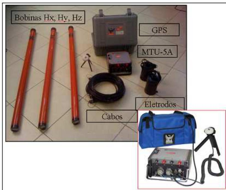
Figura 7 – Imagem do equipamento de aquisição de dados magnetotelúricos. Em detalhe: unidade central MTU-5A.
