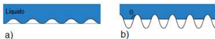
Figura 3 - Comportamento do Líquido sobre Superfície Rugosa - (a) Líquido em Contato Total com a Superfície com Picos Pouco Elevados; (b) Bolsões de Ar sob o Líquido
