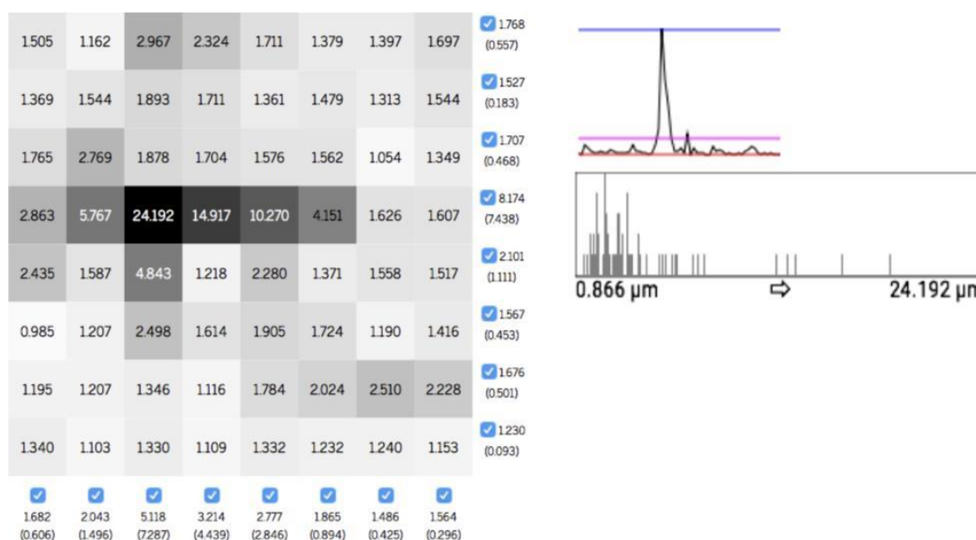
Figura 46 - Assinatura da rugosidade de uma área de 10mm x 10mm gerada pelo método apresentado na ETAPA 1 do estudo, com média e desvio padrão por linha e por coluna
