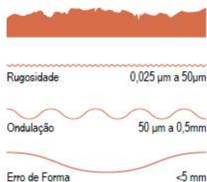
Figura 14 - Definição escalar de rugosidade, erro de forma e ondulação para blocos cerâmicos
