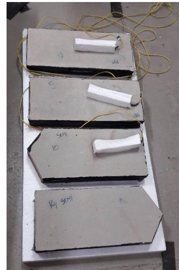
c) Placas dispostas com termopares para acompanhamento dos ciclos térmicos
