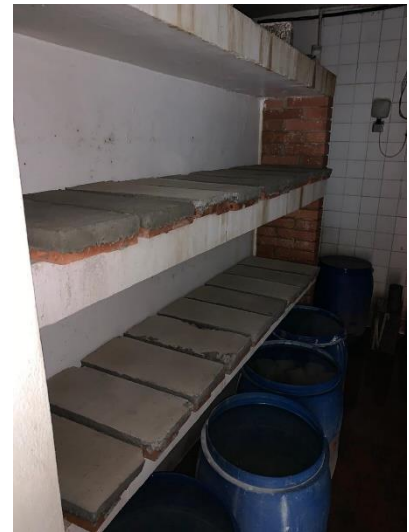
f) Placas revestidas mantidas na sala de cura;
