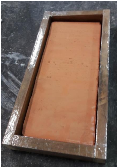
a) Placa cerâmica posicionada dentro do molde da argamassa;
