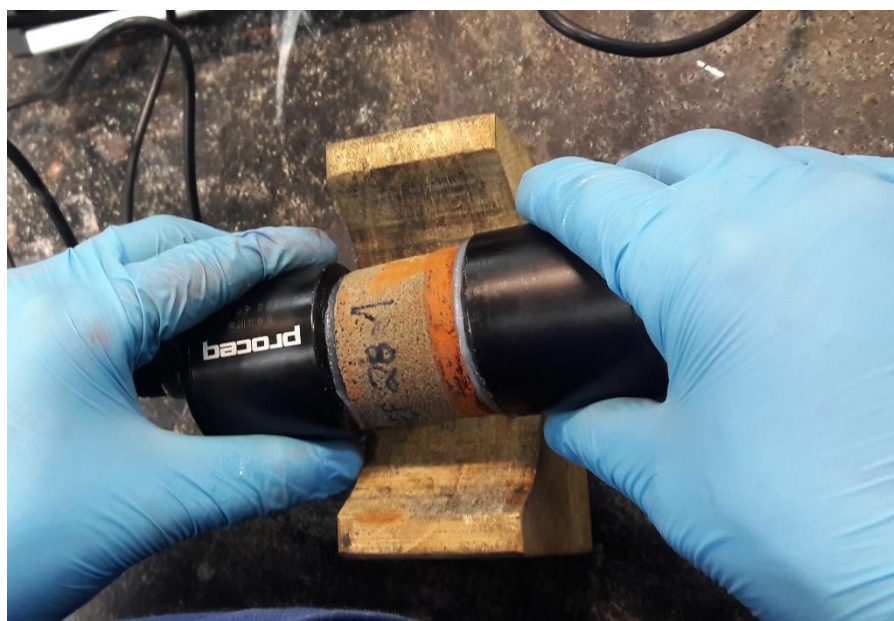
Figura 42: Ensaio de ultrassom para determinação do módulo de elasticidade nos exemplares de revestimento
