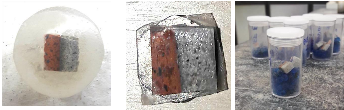
a) Amostra após processo de polimento após de b) Amostra após corte da resina c) Amostras armazenadas em um recipiente de acrílico com sílica gel
