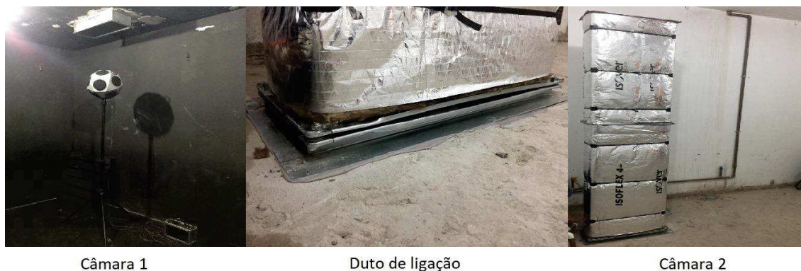
Figura 31 – Câmara 1, duto de ligação e câmara 2
