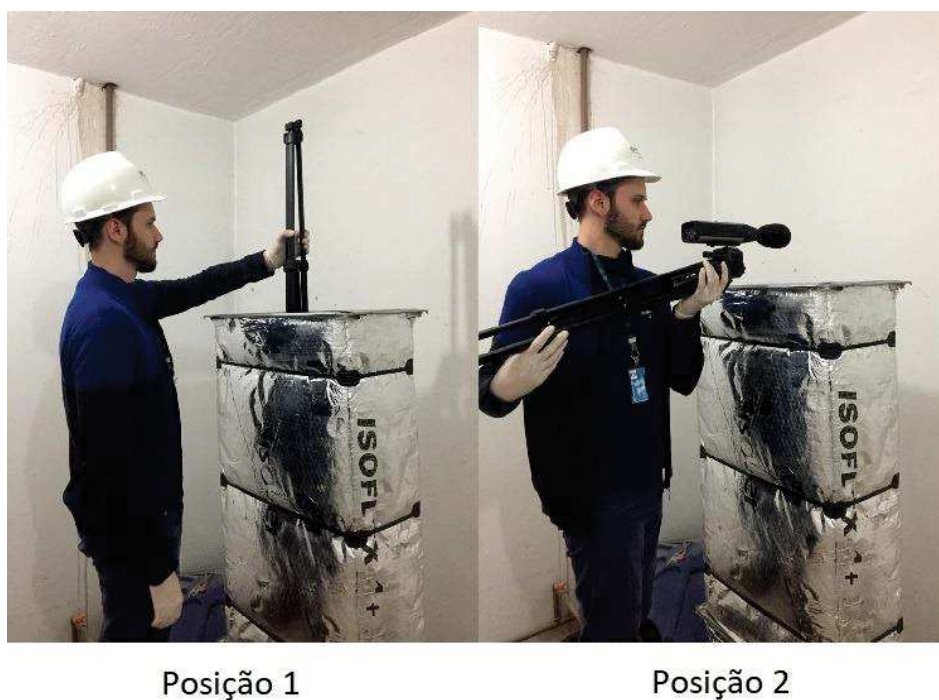
Figura 32 – Posição 1 e posição 2 de microfone durante ensaio de atenuação
