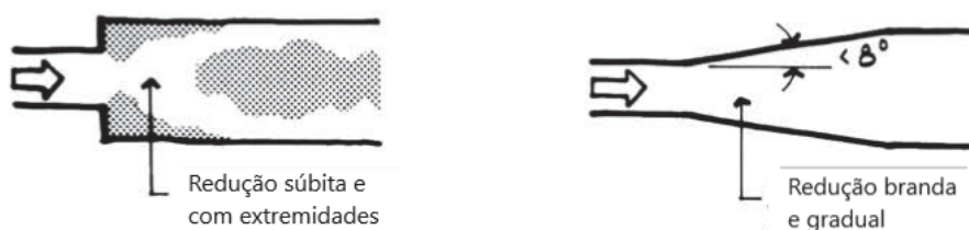
Figura 18 – Reduções em ramais de ar condicionado central
