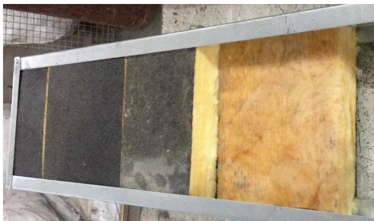
Figura 33 – Fabricação da célula atenuadora com retalhos de Isosound
