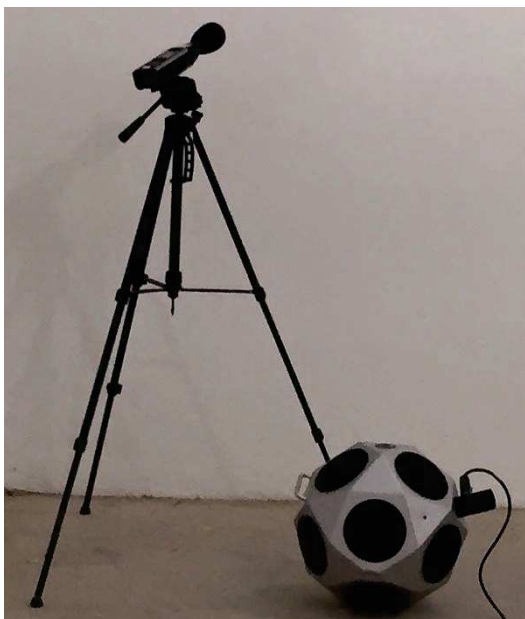
Figura 27 – Microfone e fonte sonora utilizados em ensaio
