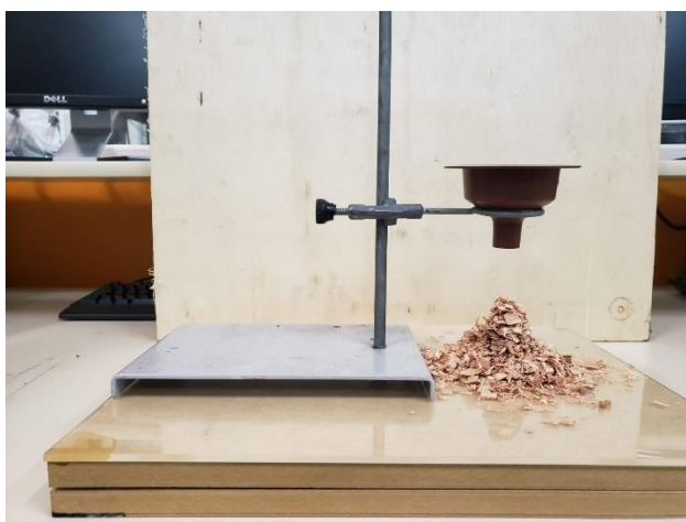
Figura 3-3. Aparato utilizado para determinação do ângulo de repouso
