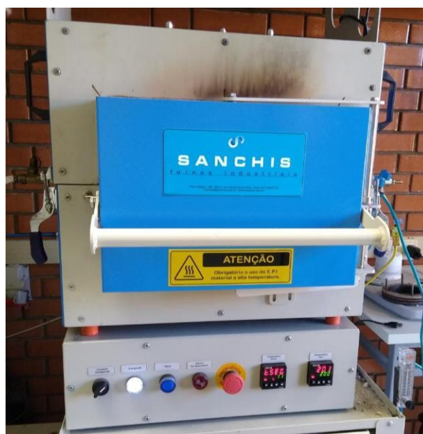
Figura 3-2. Reator utilizado para realização dos ensaios de torrefação
