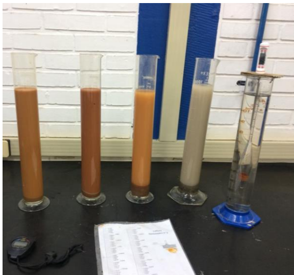
Fotografia 2 - Sedimentação das amostras
