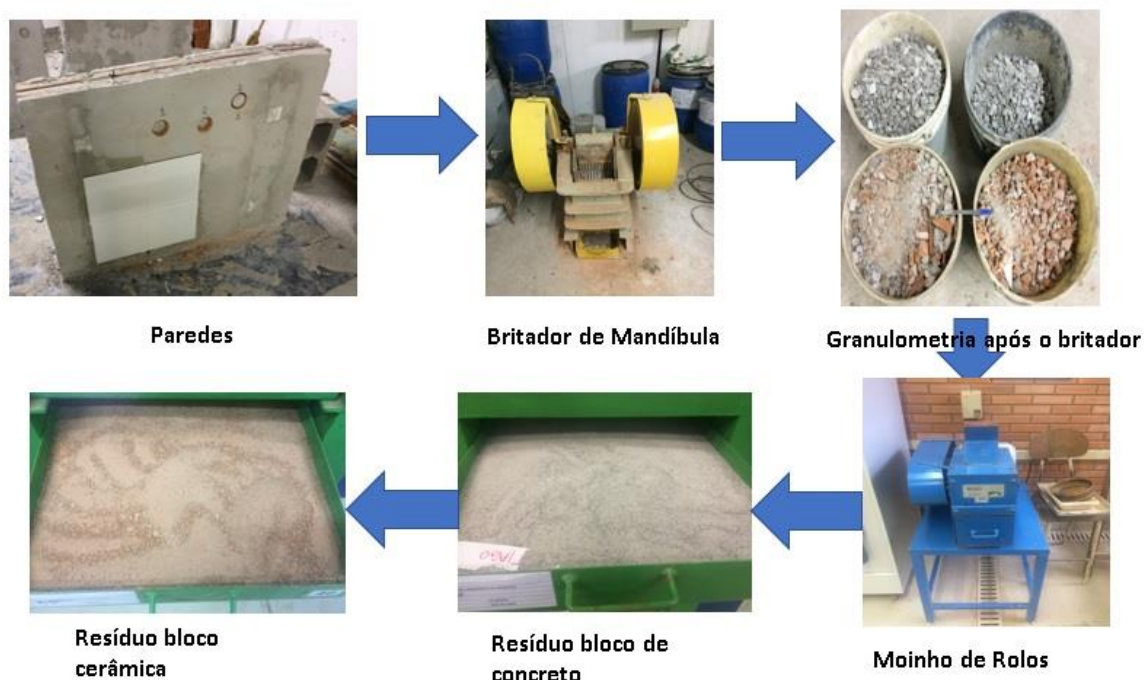
Figura 12 – Processo de beneficiamento dos resíduos
