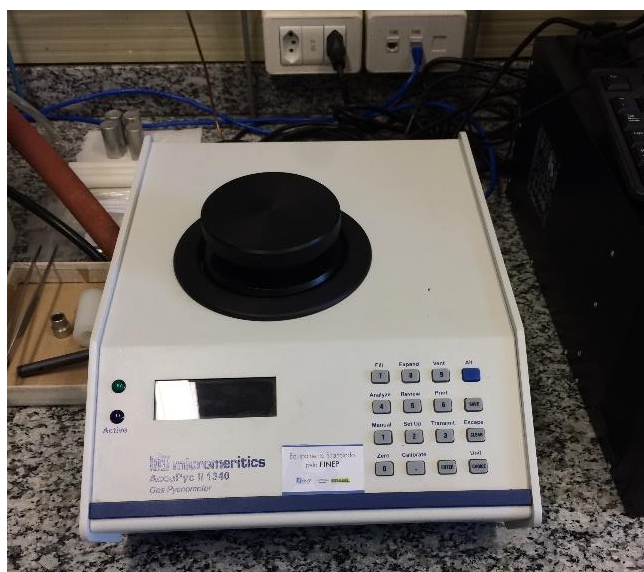
Fotografia 3 - Picnômetro por intrusão de gás Hélio
