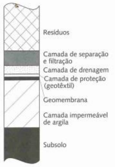
Figura 7 – Detalhamento das camadas de um aterro sanitário
