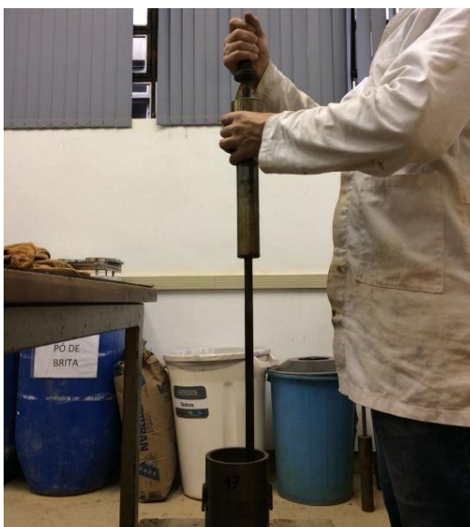
Fotografia 5 - Ensaio de compactação
