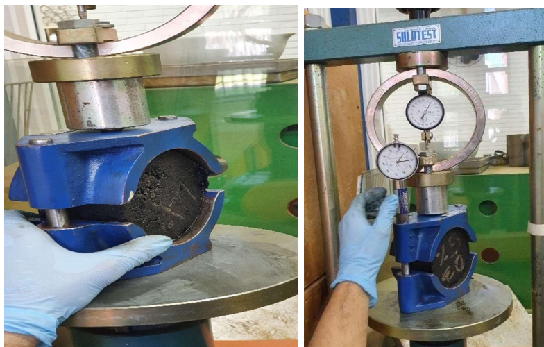
Figura 20- Corpo de prova inserido em anel para rompimento Marshall
