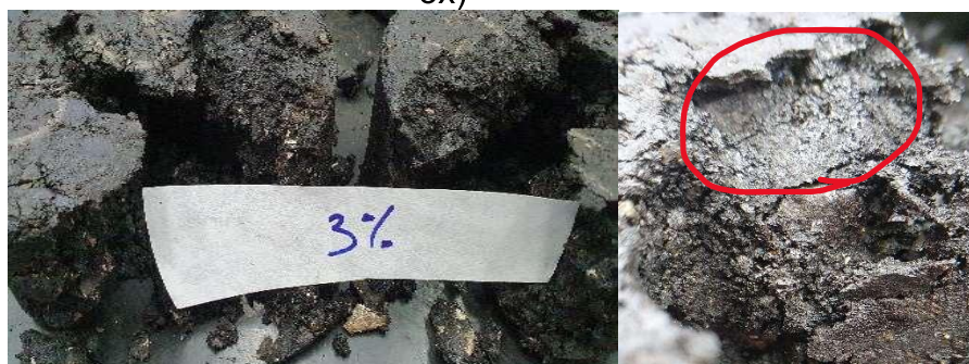
Figura 35 – Imagem por lupa da massa asfáltica com 3% de resíduo (Aumento de 3x)
