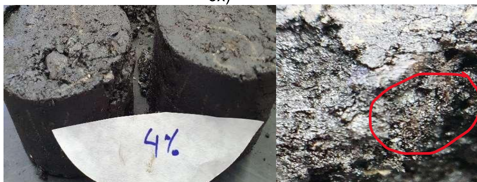
Figura 36 – Imagem por lupa da massa asfáltica com 4% de resíduo (Aumento de 3x)
