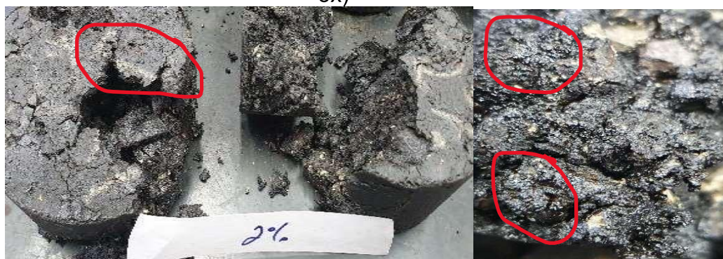
Figura 34 – Imagem por lupa da massa asfáltica com 2% de resíduo (Aumento de 3x)
