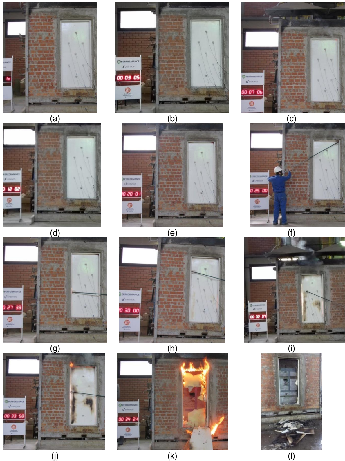
Figura 40 - Sequência de ensaio da porta P4
