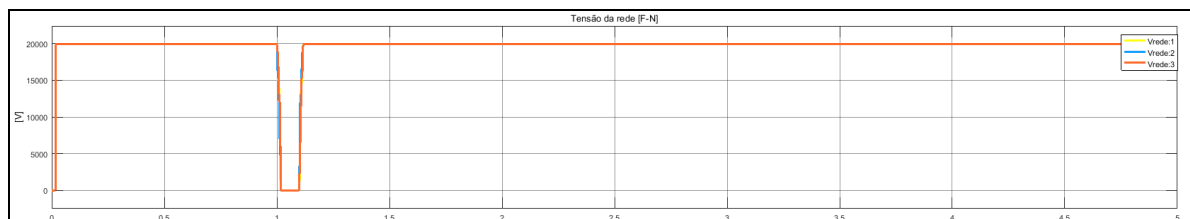
Figura 85 - Interrupção de tensão da rede para o ensaio 8
