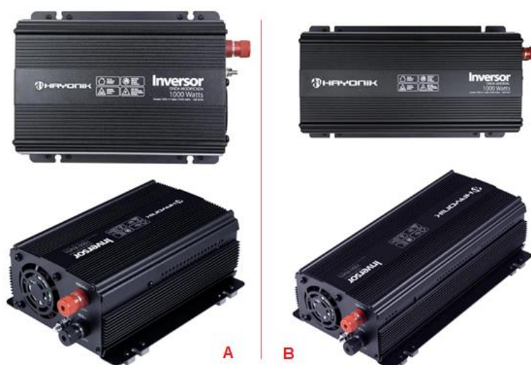
Figura 17 - Inversores de tensão adquiridos para os testes
