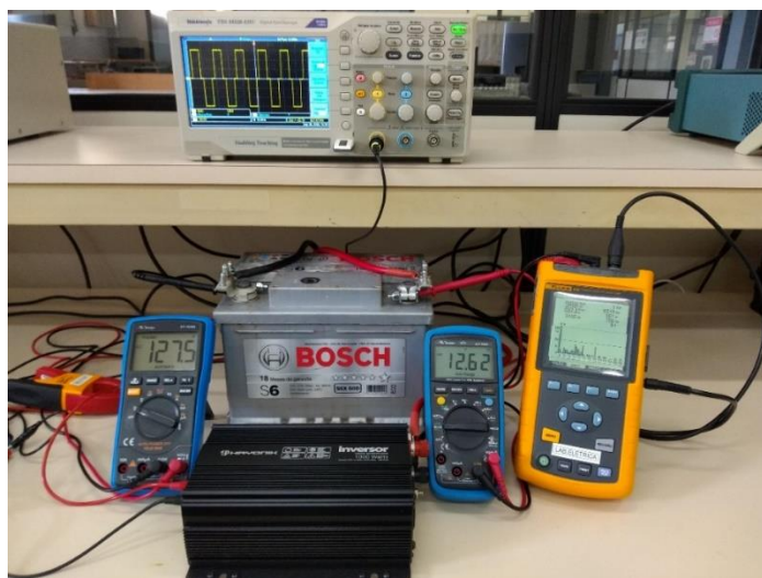
Figura 43 – Inversor de tensão onda modificada no teste sem carga
