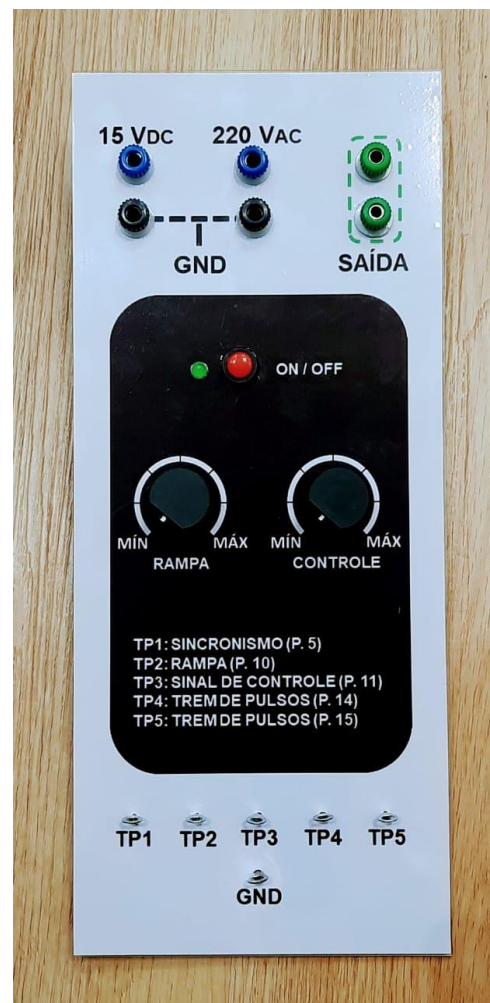
Figura 36 (b): Placa frontal do retificador controlado monofásico.
