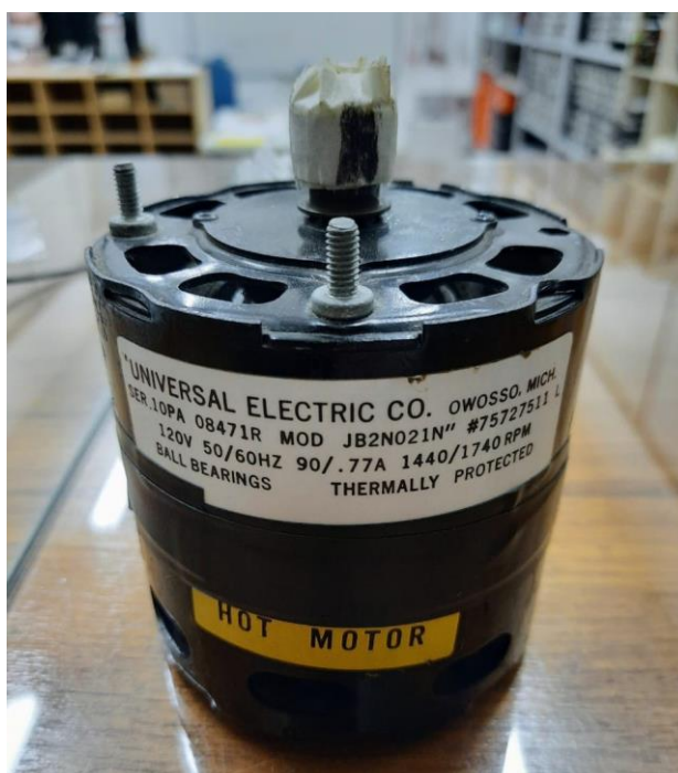
Figura 24: Motor monofásico utilizado como carga do inversor de frequência.
