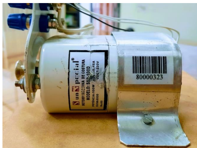
Figura 23: Motor universal utilizado como carga da softstarter .
