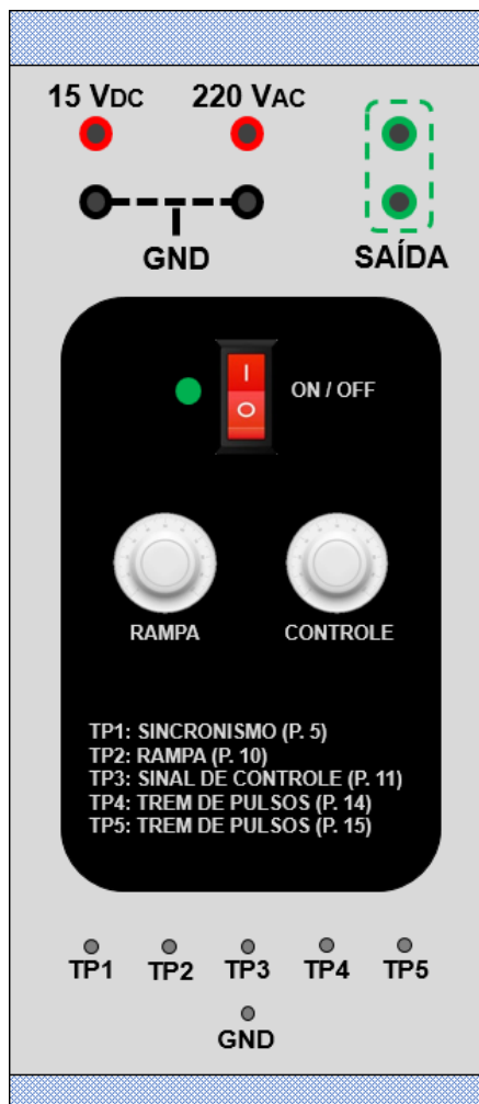
Figura 36 (a): Croqui da parte frontal da placa do retificador.
