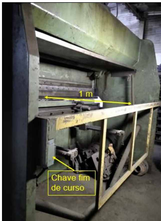
Fotografia 6 - Proteção zona traseira dobradeira hidráulica
