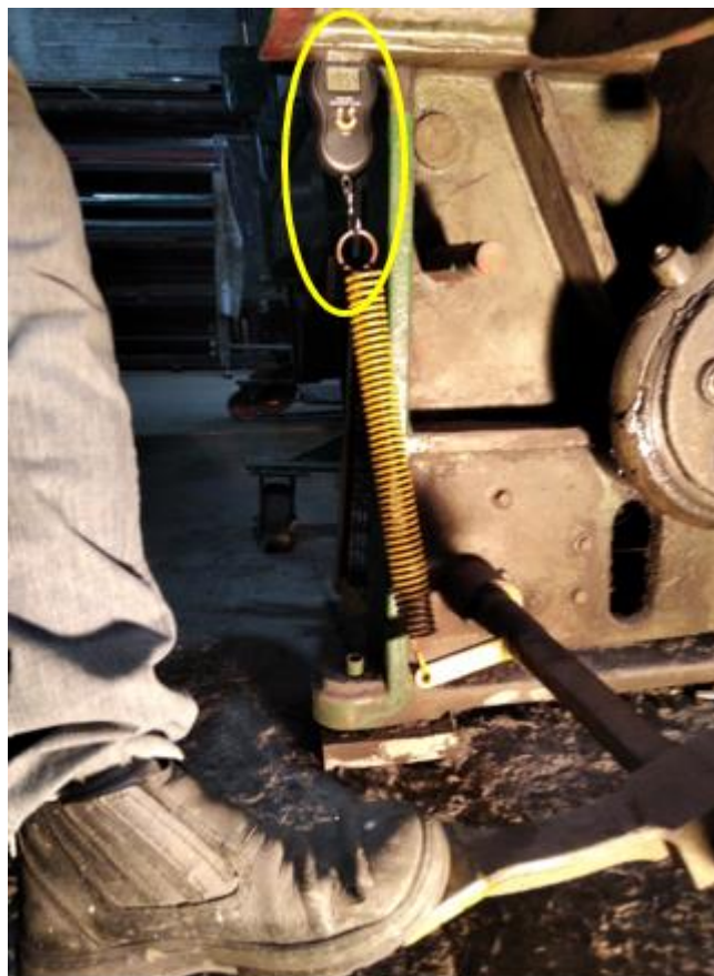
Fotografia 16 – Acionamento do pedal para medição da força
