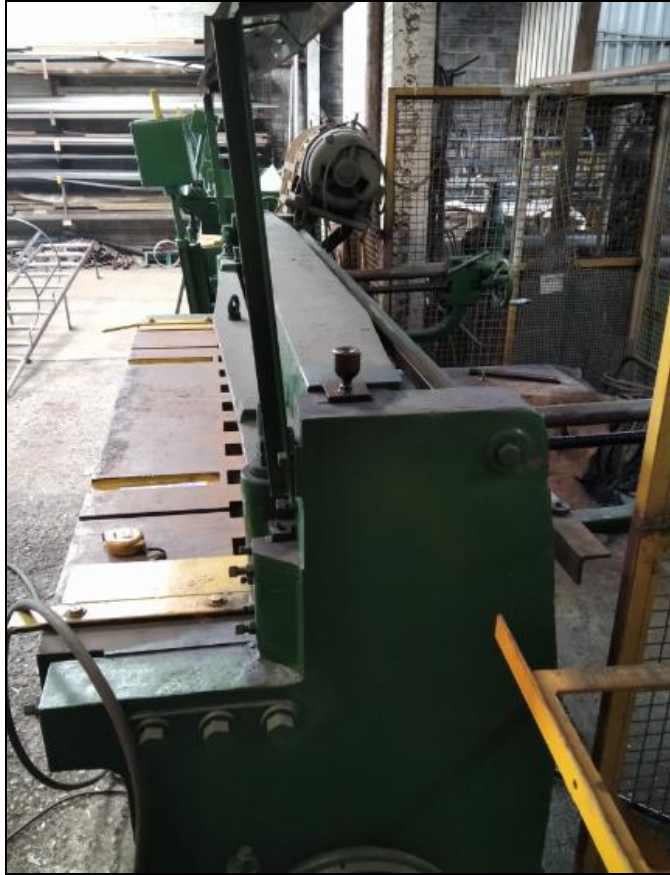
Fotografia 14 - Laterais da guilhotina sem proteção
