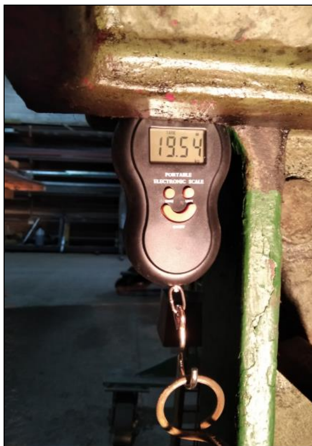
Fotografia 17 - Medição da força requerida para acionamento da guilhotina
