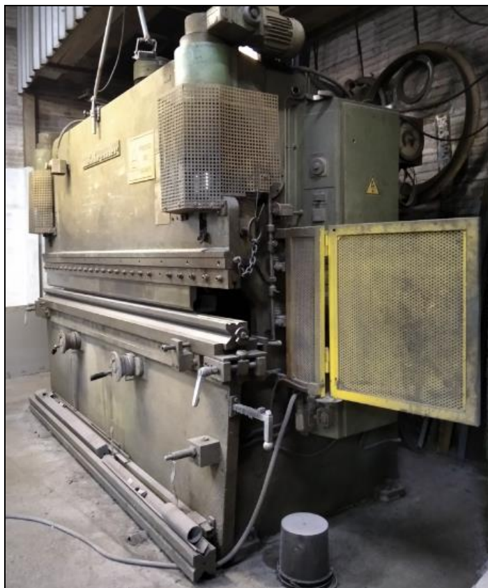
Fotografia 5 - Proteção zona lateral articulada
