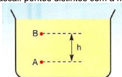
Figura 24 – Princípio de Pascal: pontos distintos com a mesma alteração de pressão
