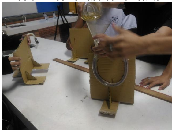
Fotografia 11 – Alunos da turma 201 verificando diferentes colunas em dois ramos de um mesmo vaso comunicante
