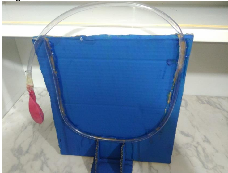
Fotografia 2 – Manômetro em U e o Teorema de Stevin
