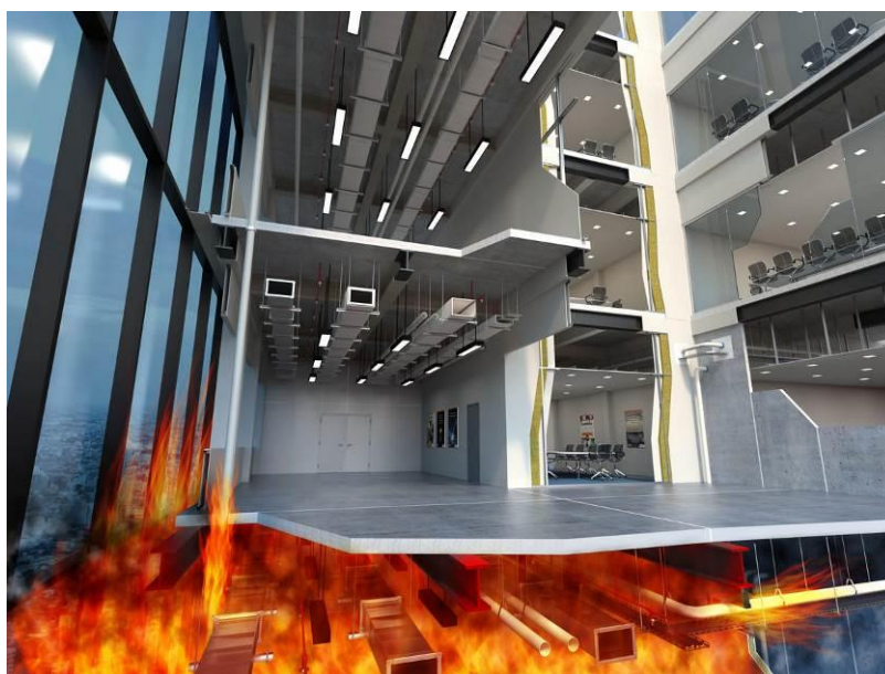
Figura 4 – Exemplificação do efeito da compartimentação
