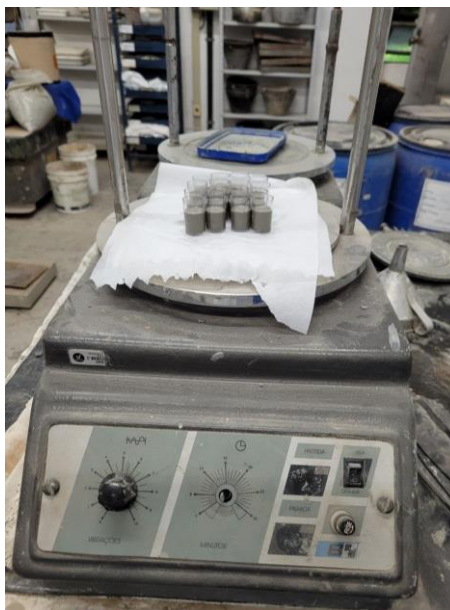
Fotografia 2 – Adensamento das amostras em agitador de peneiras
