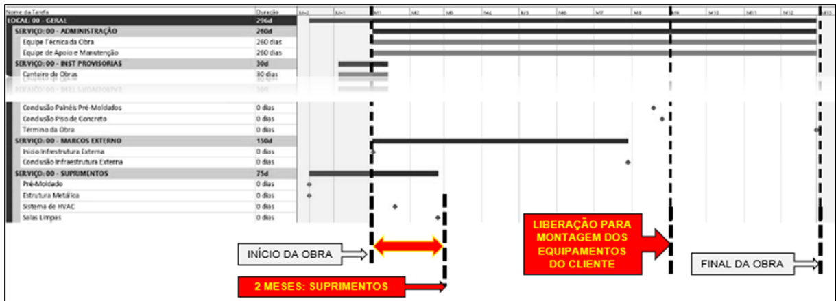
Figura 42 – Antecipação da montagem de equipamentos na produção
