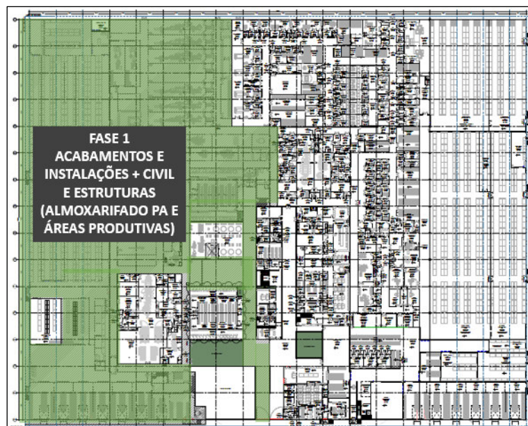
Figura 33 – Faseamento do prédio principal ajustado
