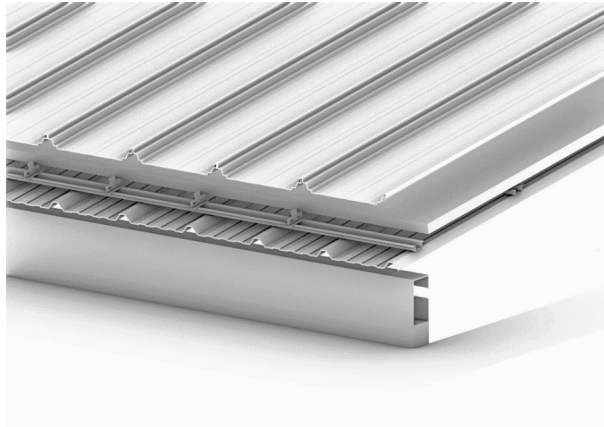
Figura 73 – Esquema de montagem da amostra com telha inferior TP-33
