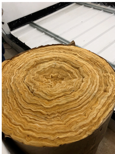
Figura 76 – Lã de vidro 50mm
