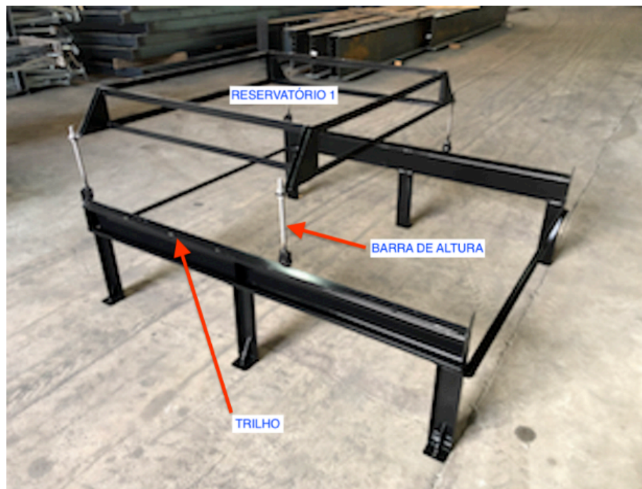
Figura 58 – Estrutura de sustentação
