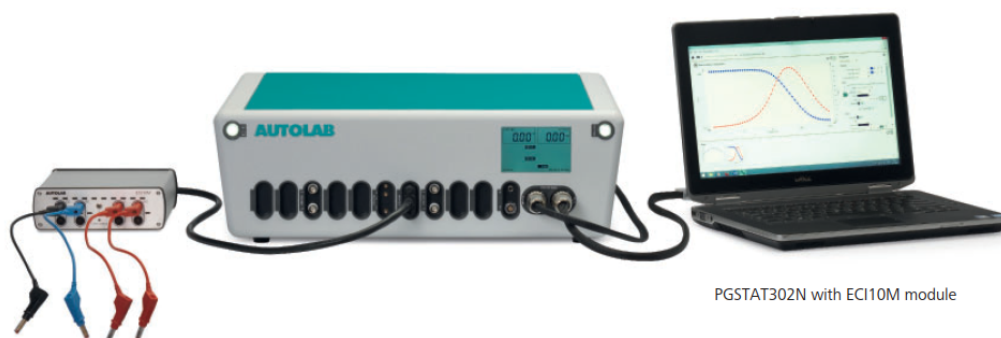
Figura 11 – Representação da utilização do PGSTAT302N.
