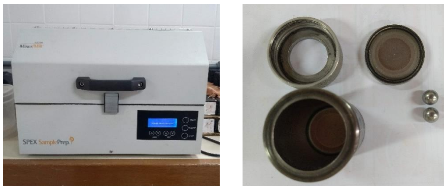
Figura 15 – Moinho de bolas e o cilindro com as esferas de aço
