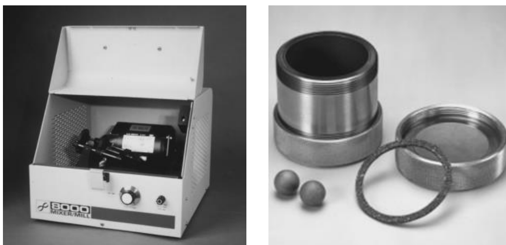
Figura 6 – a) Moinho de bolas; b) cilindro com as esferas de aço
