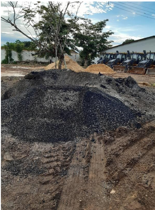
Figura 10 – Coleta do material fresado
