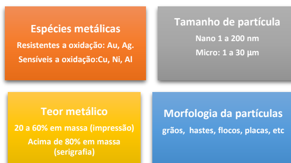
Figura 1 – Esquema para classificação de nanopartículas metálicas
