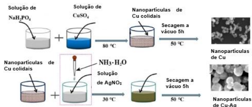
Figura 5 – Esquema de produção de nanopartículas de core-shell .
