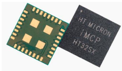
Fotografia 4 – Chip para aplicação de filme condutivo para blindagem
