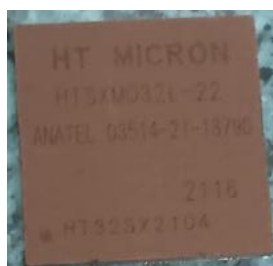
Figura 74 – Chip com cobertura da tinta Cu-Ag
