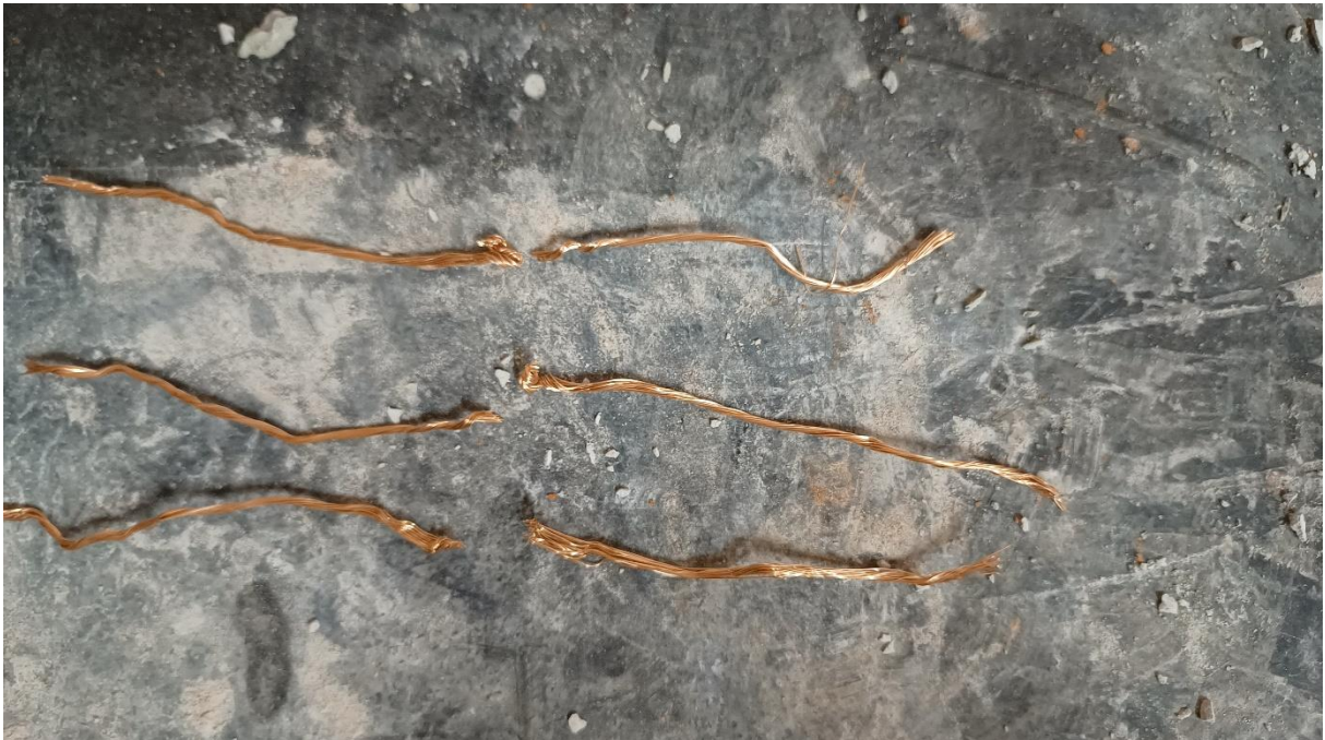
Fotografia 14 - Emenda de caixa após teste de tração
