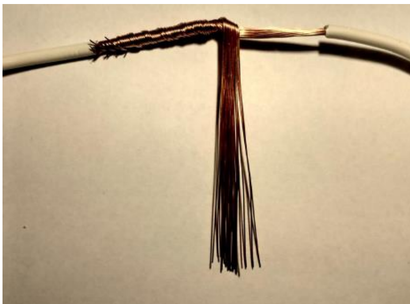
Figura 10 - Emenda em prolongamento, torção de um condutor
