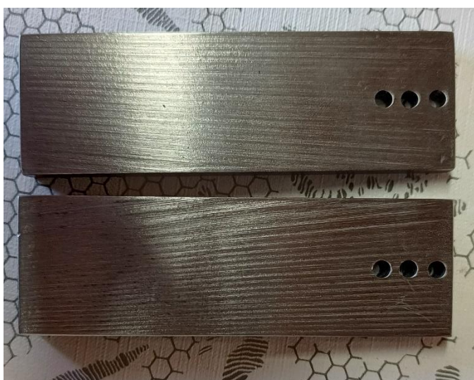
Fotografia 7 - Peça de alumínio para fixação das emendas
