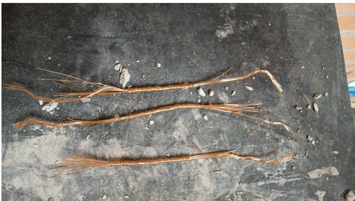
Fotografia 13 - Emenda em prolongamento após teste de tração
