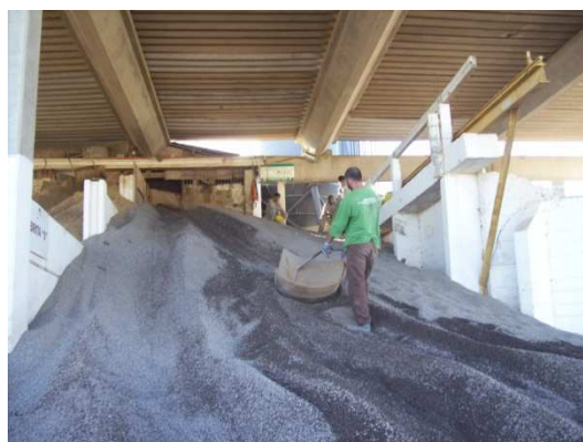
Figura 18: Transporte dos agregados- pá de arrastamento
