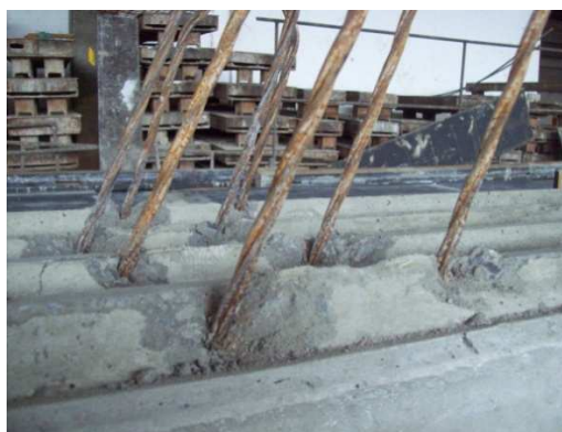
Figura 58: Quebras ocorridas nos painéis CRef e CRCT junto as alças de içamento
