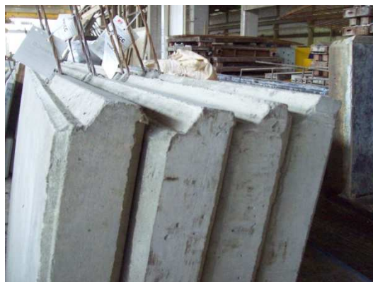
Figura 59: Acabamento final dos painéis com ARC.
